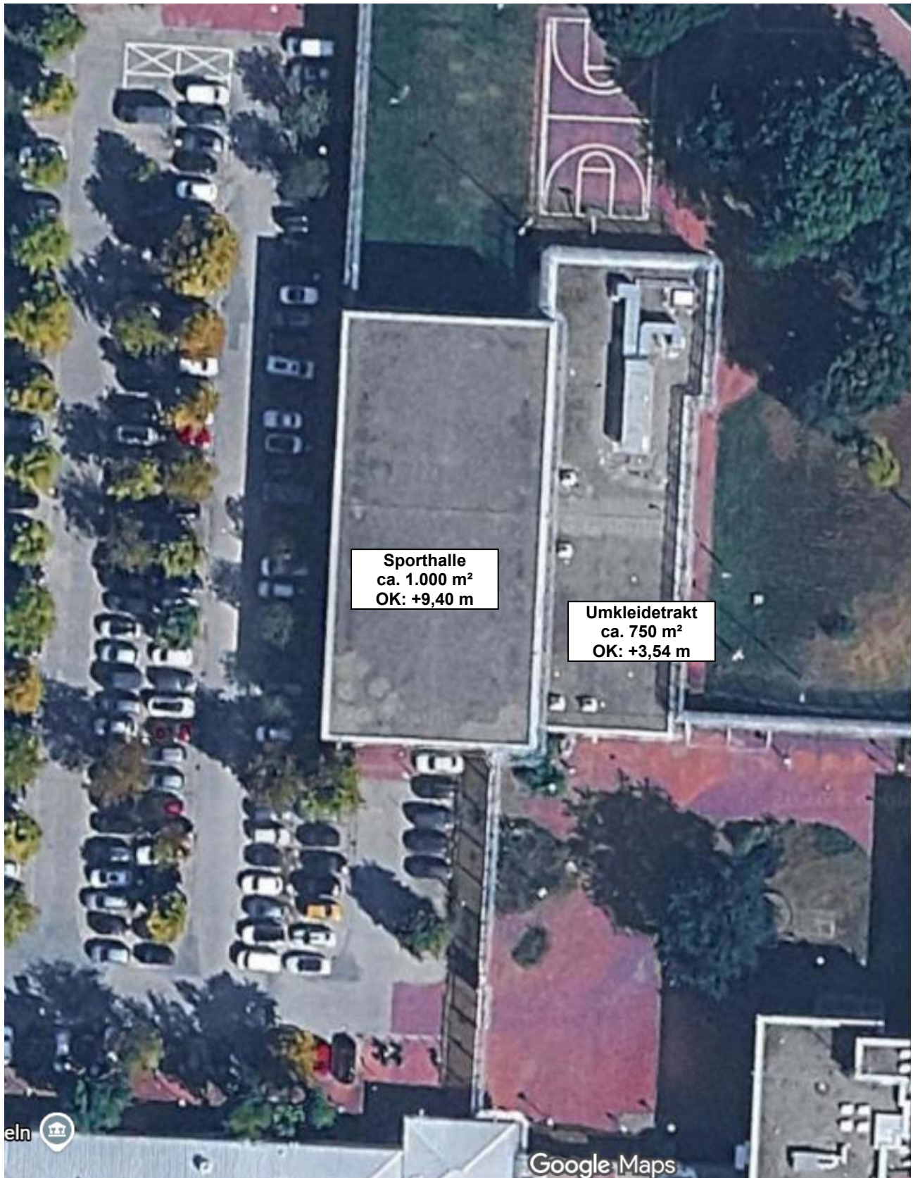
(2) Baufeld Sporthalle (Haus 2.6) – Links Sporthalle (OK Attika ca. +9,40 m) / Rechts Umkleidetrakt (OK Attika ca. +3,54 m)
